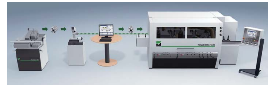
刃物研磨機、刃物測定スタンドなどの周辺機器も充実。モルダーとのオンライン接続も可能で、再研磨で変わった刃物寸法も、すぐにモルダー側に反映できます。1本目から正確な寸法の製品を生産できます。
