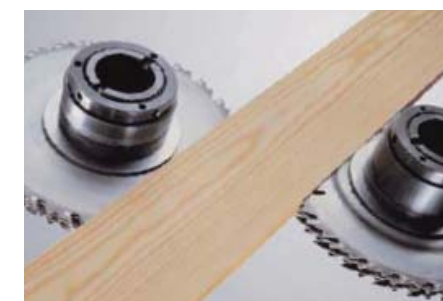
横割り装置: 左右からノコ盤を回して、複数の薄い板材に挽き割ることができます。スプレー装置によりノコの摩擦も軽減します。
