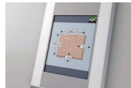
メモリー・プラス: 製品寸法と刃物寸法を簡単に登録・呼び出しができます。セットアップ時間を大きく短縮できます。
