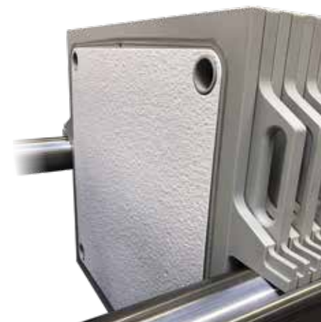
フィルターフレームと組み合わされたO-リングガスケット
