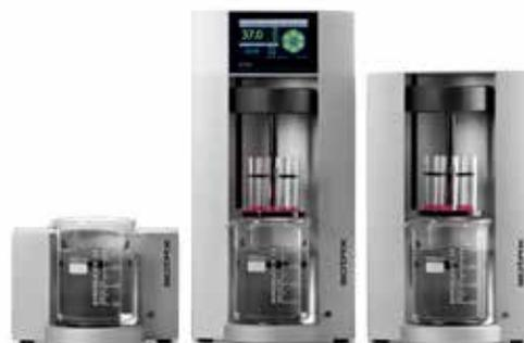
1台の親機につき、イーサネットケーブルによる接続で最大3台までの子機との接続が可能です。測定セルは容易に取り付け、取り外しをすることが可能です。測定終了後は、各セルの錠剤ごとの崩壊時間、そして崩壊時の温度帯などが自動で保存されます。
