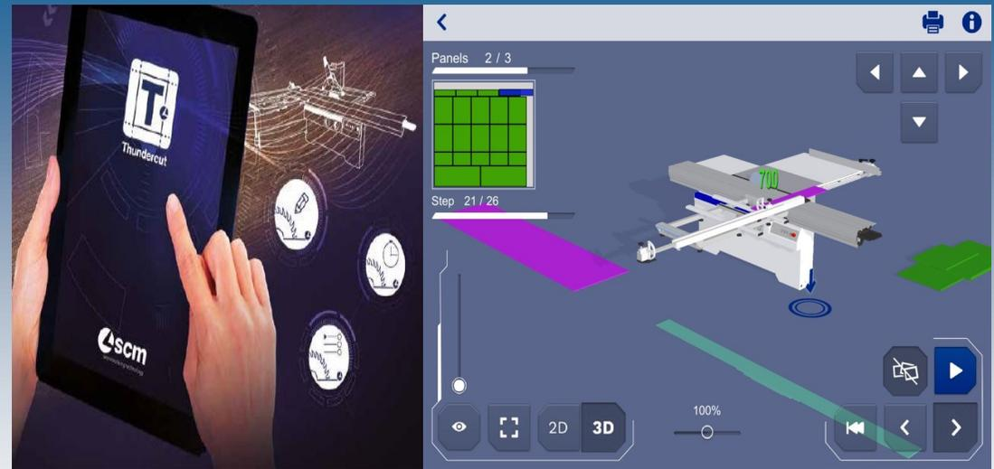
タブレット用の木取りアプリケーション“Thundercut”がカットパターンの最適化を実行、ホルターにカット順序を指示。3Dグラフィックで視覚的にカット順序を確認可能です。
