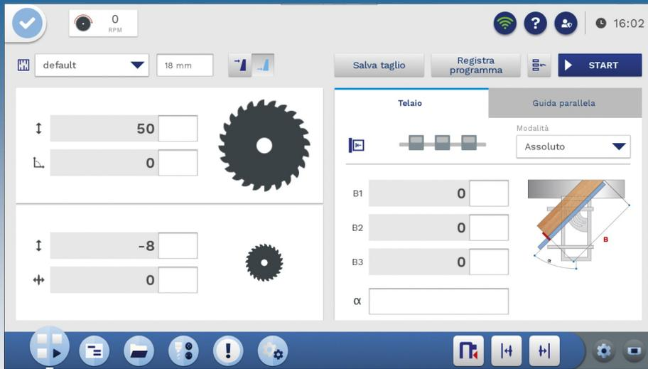
新型操作パネル“eye-S”が簡単かつ直感的な機械操作を実現。鋸の昇降/傾斜、リップフェンス位置決めをNC制御でセッティングします。
